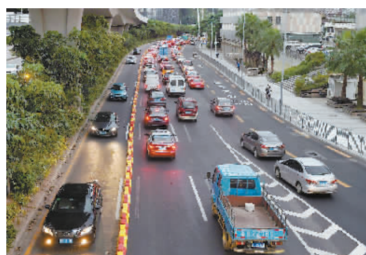
10月24日,车辆在深圳的潮汐车道上驶过。当日,可全自动机械化地“吞吐”道路隔离带的潮汐车道“拉链车”在广东深圳上岗,国内首条快速路自动化潮汐车道正式启用。
