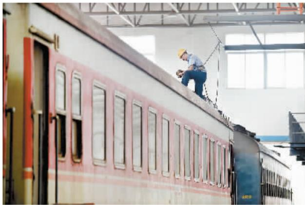
7月25日,空调机组的检修工人在列车车顶拆卸空调机组防护罩。
