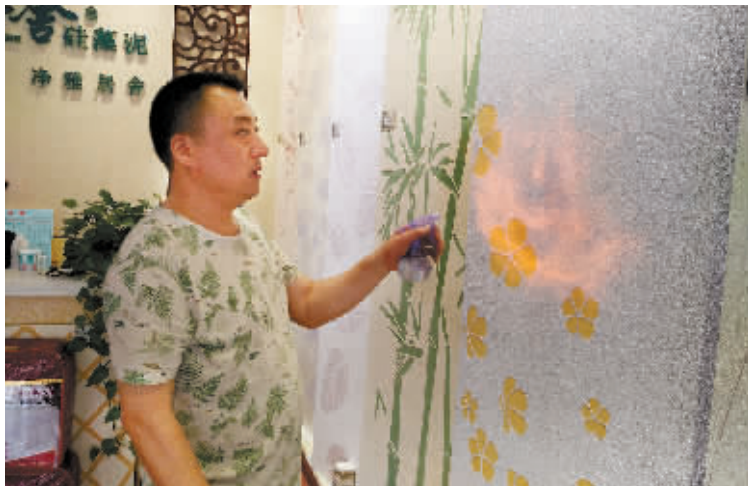
图为刘万庆在硅藻泥墙面上做喷火实验。方慧玲 摄
