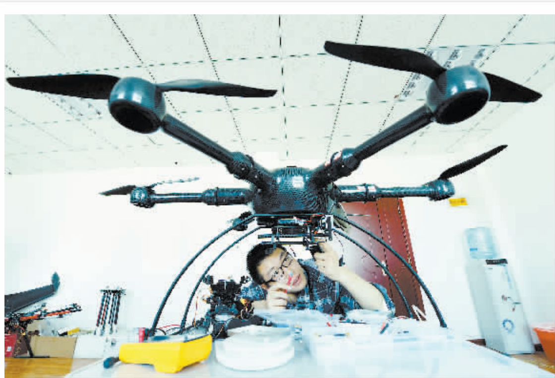
5月8日,在兰州高新技术产业区大学生创业苗圃,杨启帆在组装全碳纤维多旋翼一体机。1990年出生的杨启帆是兰州理工大学电信学院电气工程专业研二学生。在校期间,从小爱捣鼓电气设备的他长期到学校实验室搞研究创造,在不断的努力和积累下,杨启帆创造发明了全碳纤维多旋翼一体机和基于DSP(数字信号处理器)的飞行控制系统,并成功申请了国家专利。
