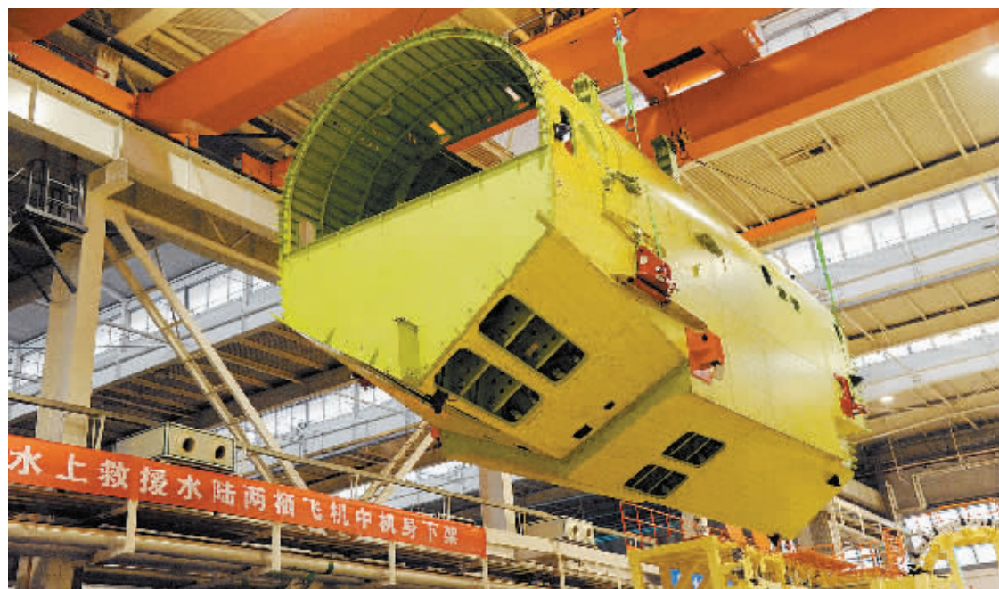
12月29日,大型灭火/水上救援水陆两栖飞机AC600首个大部件——中机身在中航飞机西安分公司顺利下架,标志着AC600飞机进入整体装配阶段,项目研制取得阶段性成果。新华社记者 李华 摄
