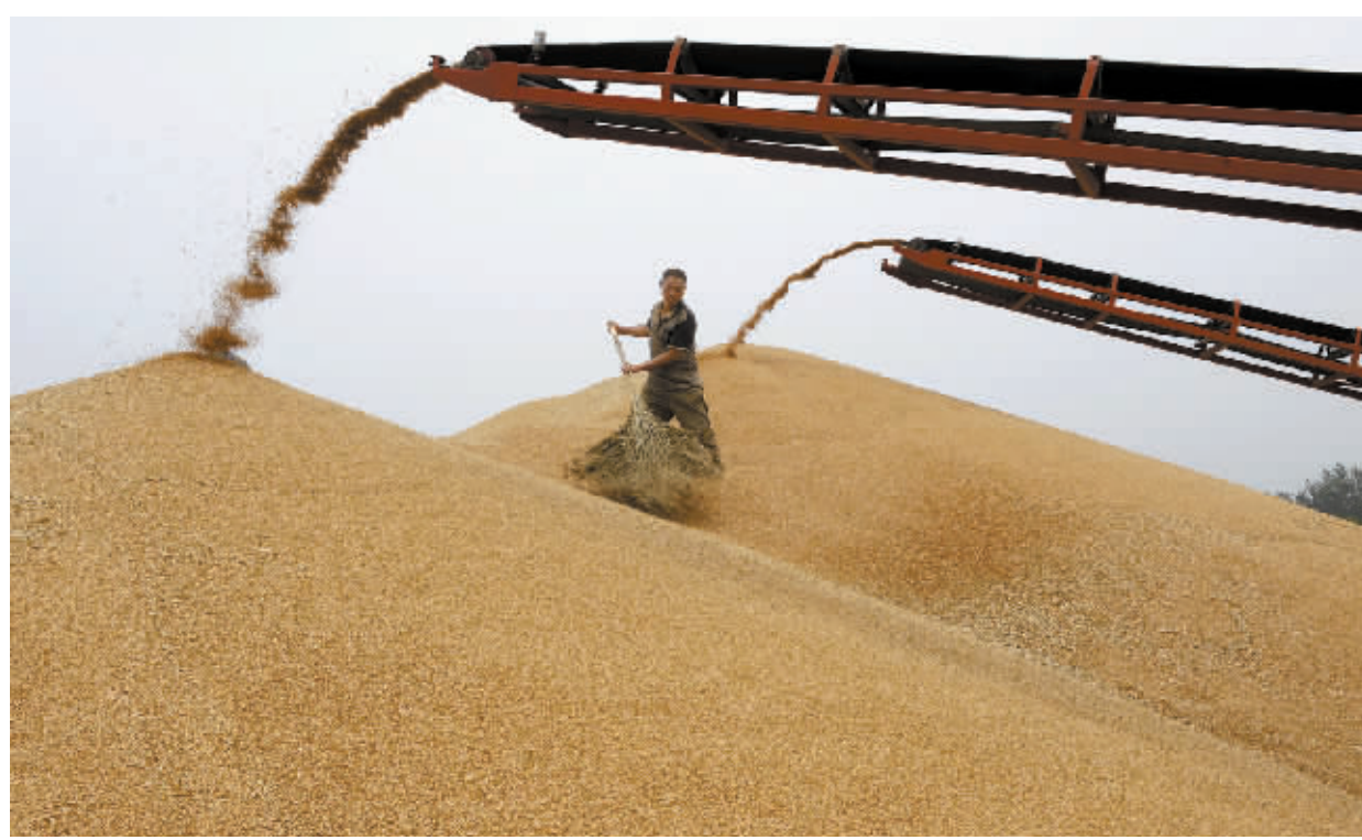
7月1日,在中央储备粮管理总公司郑州直属库内,一名工人对入库的小麦进行入库整理。河南省夏粮收购工作正在有序展开,中央储备粮管理总公司郑州直属库收粮15万吨,比去年同期增长6万吨。郑州直属库采取智能通风等科技手段,减少虫、霉、鼠、雀危害,采用散装、散卸、散存、散运的“四散”粮食物流技术,有效减少粮食在运输、仓储环节的损耗。
