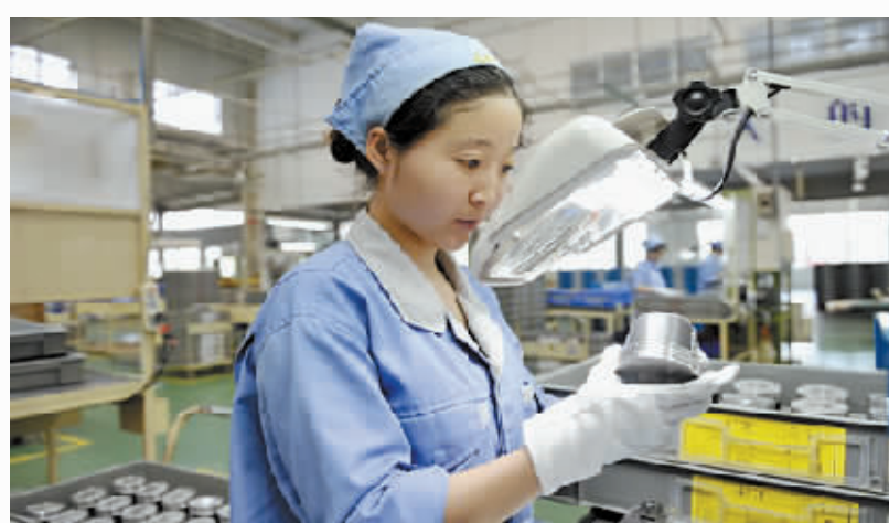
AAT公司,工人正在检测汽车发动机核心部件——活塞
