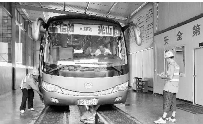
为确保车辆行车安全,信阳汽车站强化安全管理,狠抓安全细节,每天严格对站内营运客车的车况车貌、转向、制动、传动、照明、轮胎、悬挂、随车安全设备等进行安全例检,切实消除各类安全隐患。图为7月16日该站安全例检员正在对客车“体检”。
