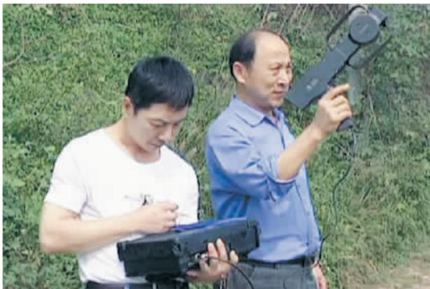
图为该局工作人员利用无线电测向设备查找非法电台
